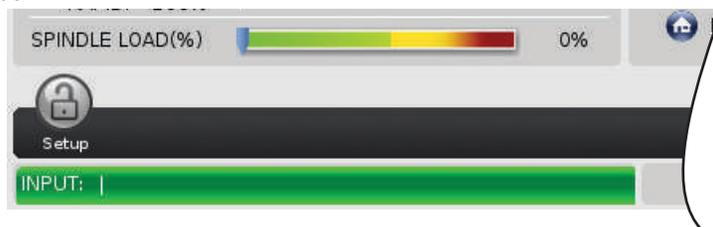
La barra de entrada es la sección de entrada de datos ubicada en la esquina inferior izquierda de la pantalla. Aquí es donde aparece su entrada cuando la introduce.
